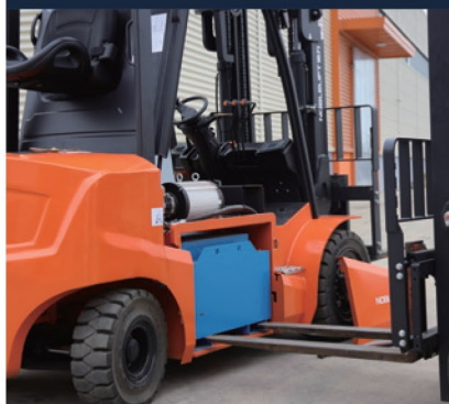
Extracción lateral de la batería para una sustitución fácil y rápida
