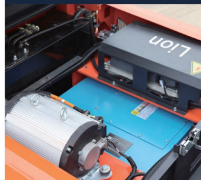
Diseño abierto del controlador y del motor de elevación para un mantenimiento más cómodo
